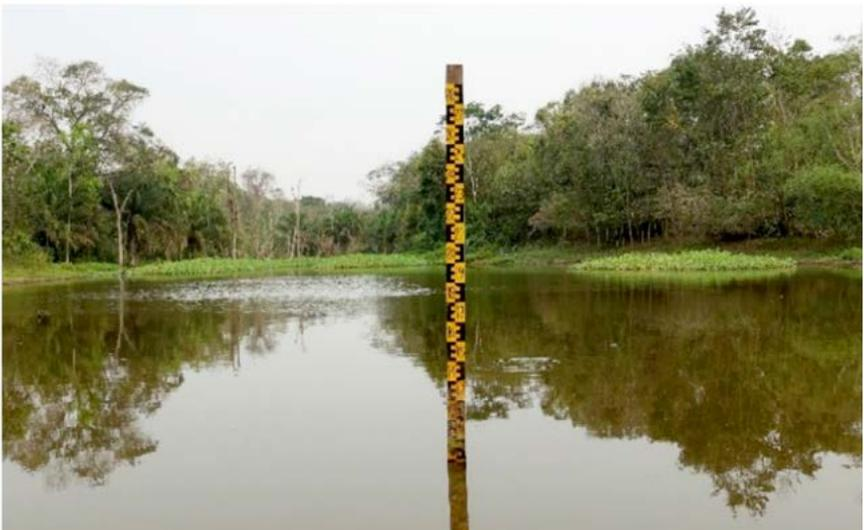
Limnómetro instalado en uno de los atajados de Alta Vista
